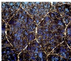
Ochrana svahov a brehov georohožami (typu Macmat®), ktoré sú počas výroby spevnené dvojzákrutovou oceľovou drôtenou sieťou.
